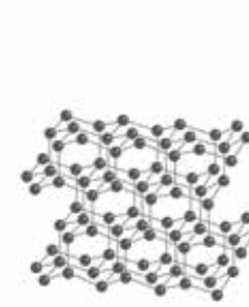
Diamant flächenzentrierter kubischer Kristall
